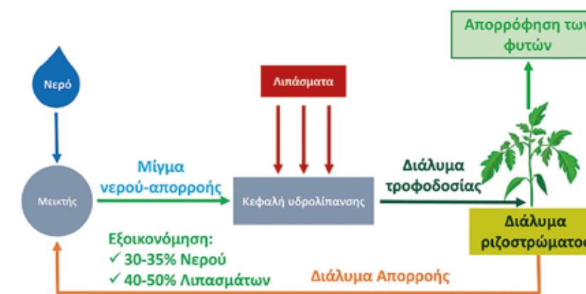
ΣΧΗΜΑ 1 - Κλειστό υδροπονικό σύστημα σε υπόστρωμα
